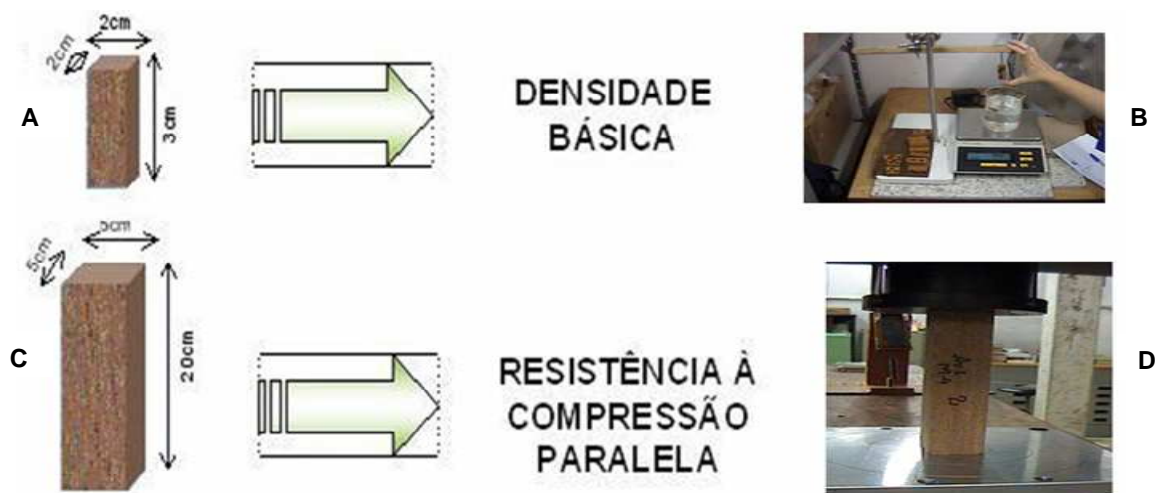
Figura 1 – Representação das amostras de S. micranthum para análise (A e B) da densidade e (C e D) da resistência à compressão a paralela às fibras.
