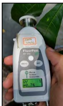
Figura 3. Aferição dos dados de fluorescência do fotossistema II utilizando-se de um fluorômetro digital (FSII) portátil (FluorPen FP100) e clips de aclimatação ao escuro. Foto: Valdir Ribeiro.
