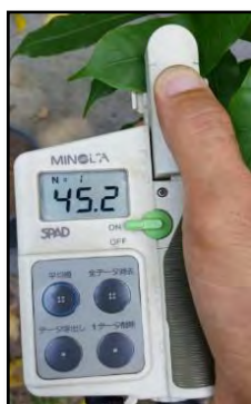
Figura 2. Aferição do teor relativo de clorofila utilizando-se de um medidor de clorofila portátil (SPAD). Foto: Valdir Ribeiro.
