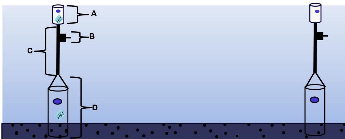
Figura 2: Esquema do tanque com as armadilhas de eclosão posicionadas no sedimento. A- Garrafa de polietileno de 100 mL. B- Registro para ser fechado antes da retirada das amostras da garrafa para evitar a entrada organismos da coluna de água na armadilha. C- Mangueira de conexão entre o tubo e a garrafa. D- Tubo transparente com 10 centímetros de sua extremidade enterrado no sedimento.
