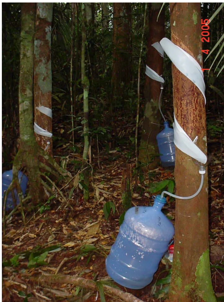
Figura 5: Coletor do tipo colarinho desenvolvido especialmente para a coleta de stem flow para análise de Hg total.
