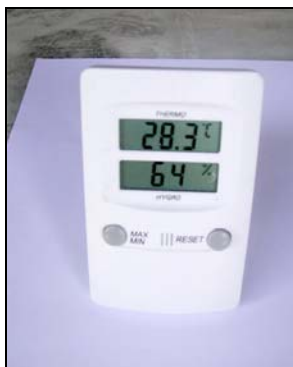
Fig.6- Termohigrômetro utilizado para medidas de temperatura e umidade relativa do ar no local.
