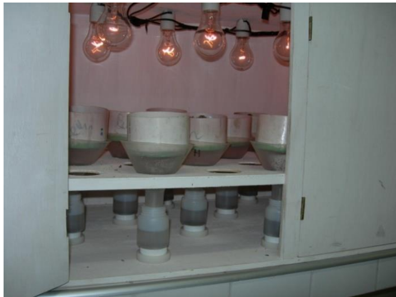
Figura 8. Extrator de Berlese-Tullgren modificado utilizado com recipiente telado acoplado ao funil e pote coletor para minimizar a queda de solo na amostra. (Fonte: Morais 2000)
