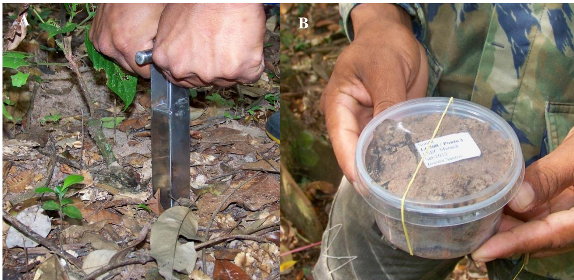
Figura 7. Sonda metálica retirando uma amostra do solo e serrapilheira (A) e recipiente plástico contendo uma subamostra composta (B). (Foto: Inaura Santos)
