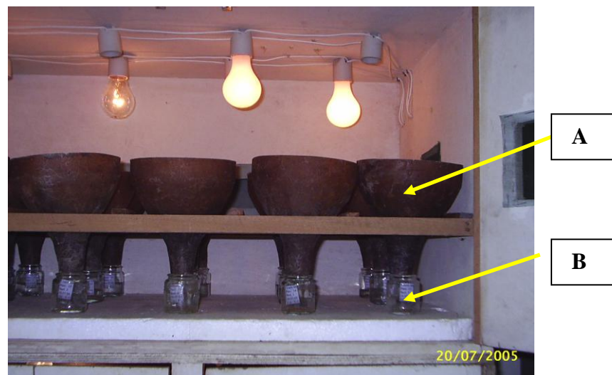
Figura 5 –Aparelho de Berlese-Tullgren: Funil (A), vidro de 67 ml (B) Foto: E. Oliveira
