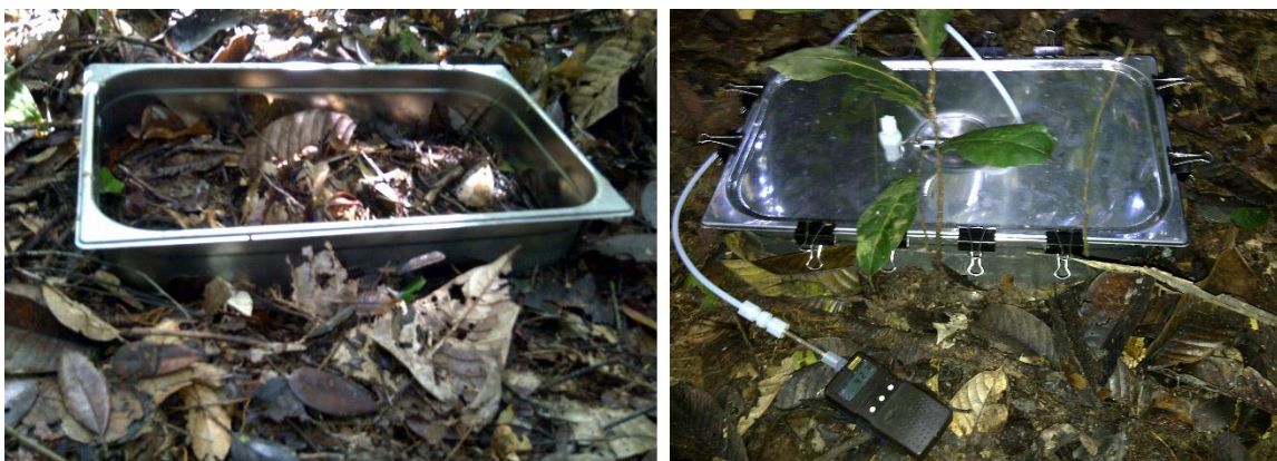
Figura 2. À esquerda, base da câmara. À direita, câmara com a tampa fixada à base, bomba e cartuchos acoplados, no momento da amostragem.
