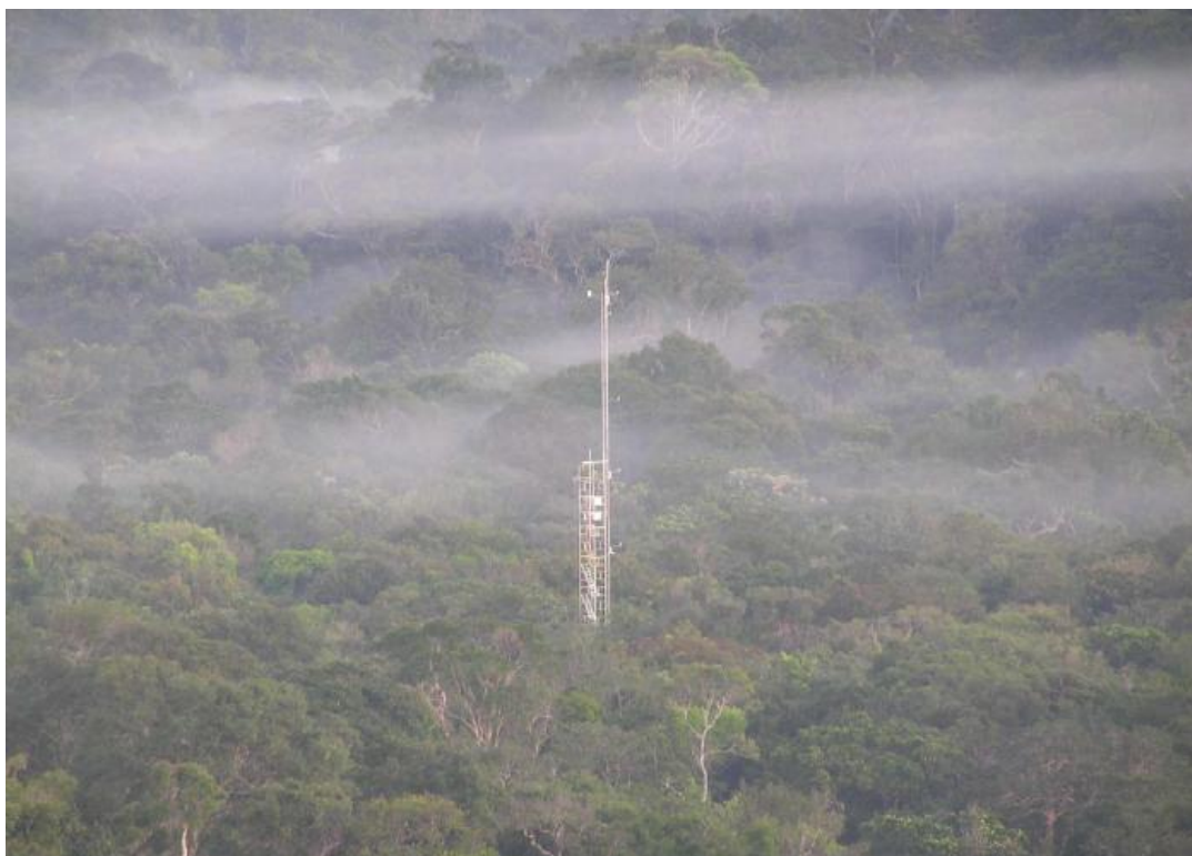
Figura 2 – Imagem ilustrativa de uma das principais torres de fluxo de carbono em operação na Amazônia (torre K34 /baixio, em Manaus). Fonte: Araujo, (2009).
