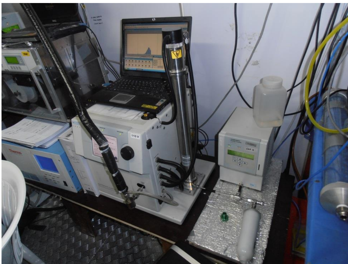
Figura 11 – Ilustração do sistema de medida de distribuição de tamanho SMPS. A figura ilustra um DMA ( Differential Mobility Analyzer ), que mede a mobilidade elétrica das partículas, à esquerda, acoplado ao CPC ( Condensation Particle Counter ), que conta o número total de partículas, à direita. Em cima do CPC está a garrafa contendo butanol, cujo vapor condensa sobre as partículas muito pequenas, aumentando seu diâmetro e permitindo que sejam contabilizadas pelo laser do CPC.
