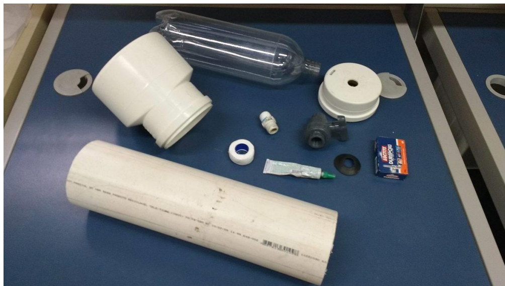
Figura 4 - Material utilizado para confecção dos pluviômetros artesanais Fonte: AGUIAR, D. G., 2016.
