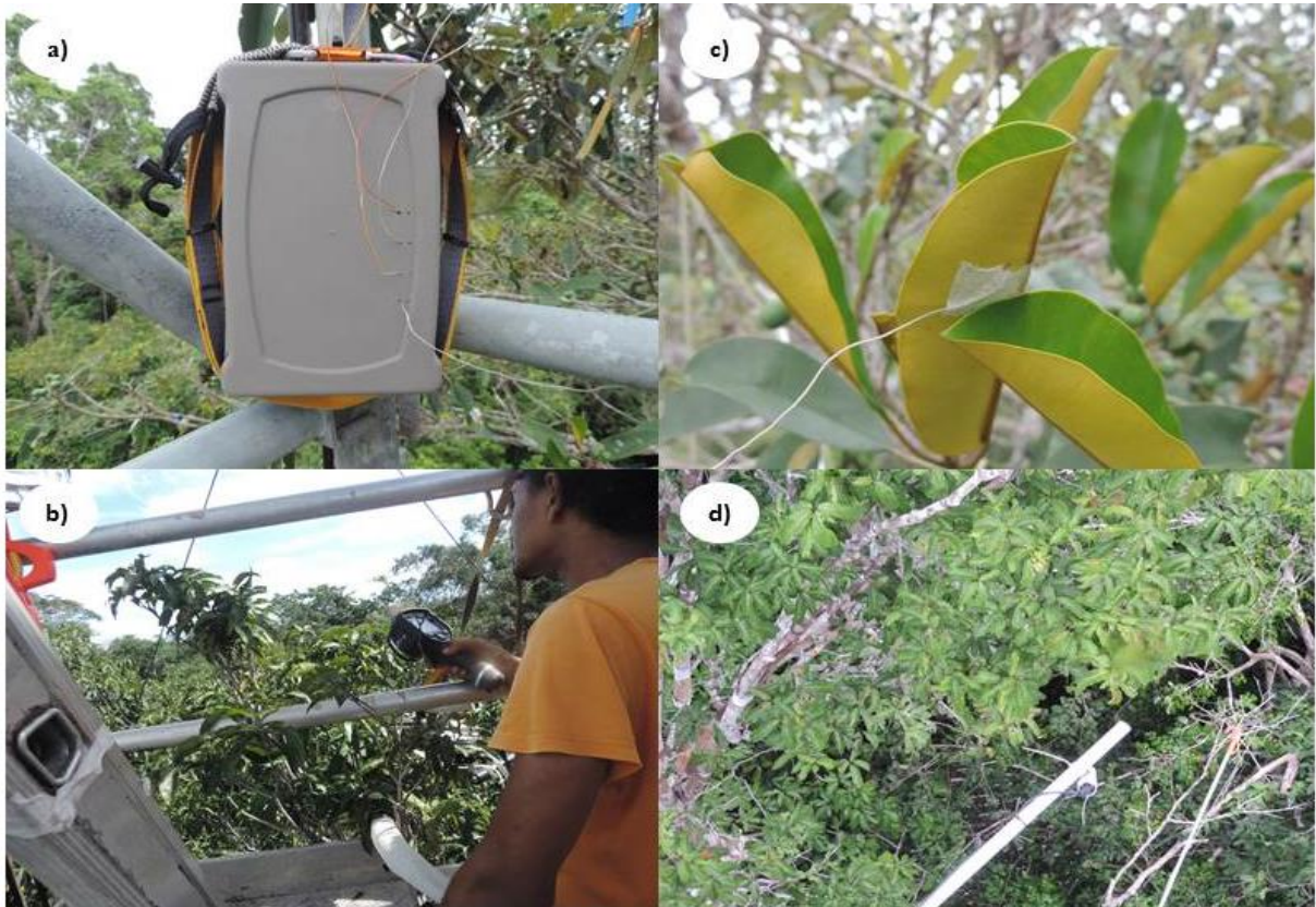
Figura 5. Condução do experimento em campo. A) Equipamento termocouple para aferição da temperatura foliar. B) Aferição com camera termal digital, FLIR. C) Sensor de temperatura tipo T conectado ao termocouple e sobre a superfície da folha. D) Sensor infra vermelha que afere a temperatura da copa.
