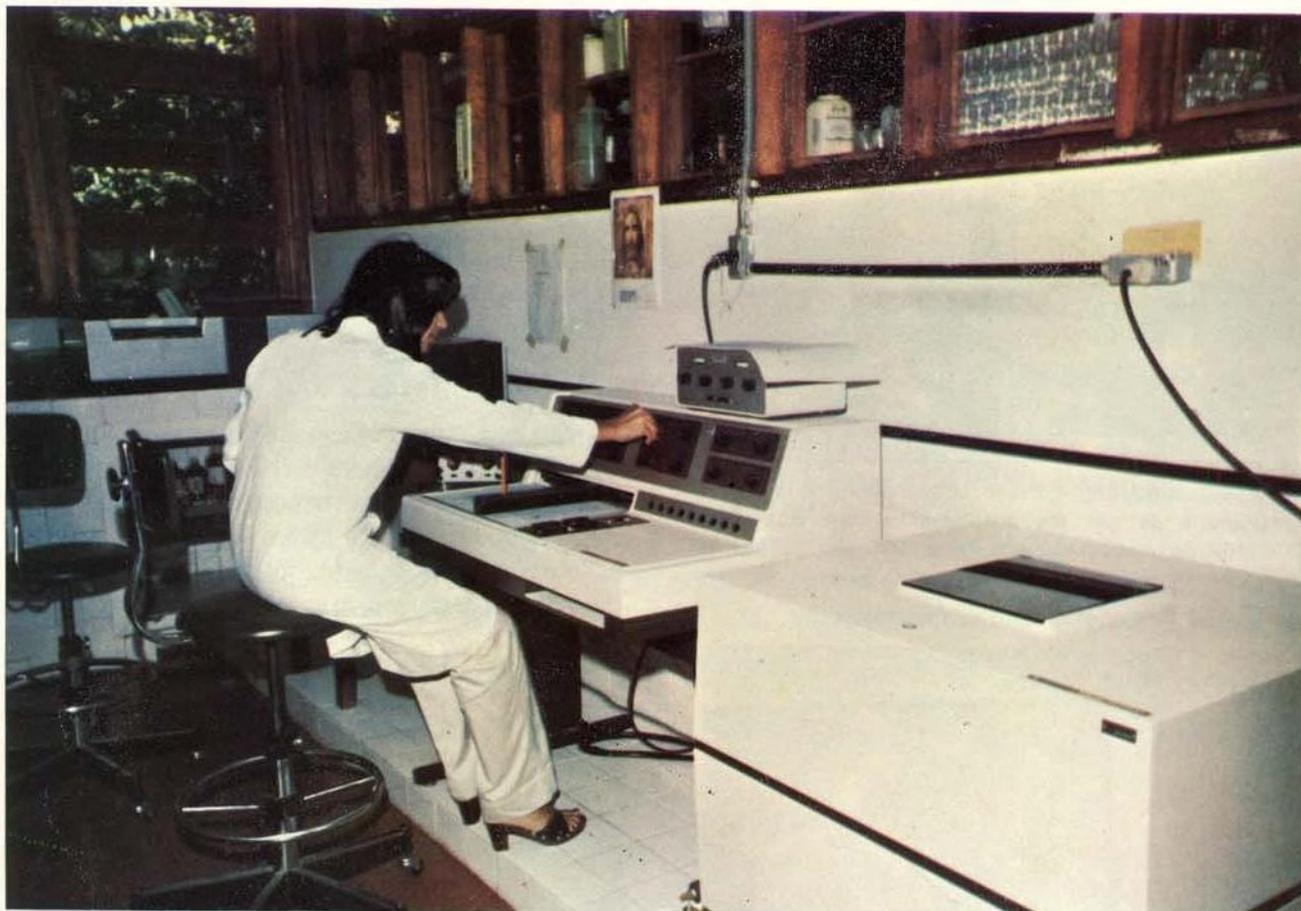
Fig. 1 — Laboratório de espectroscopia. Análise por ressonância magnética protônica (RM'H).
