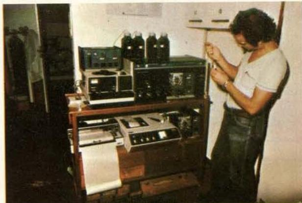
Fig. 5 — Projeto Óleos e Vitaminas. Análise por cromatografia líquida de alta pressão.
