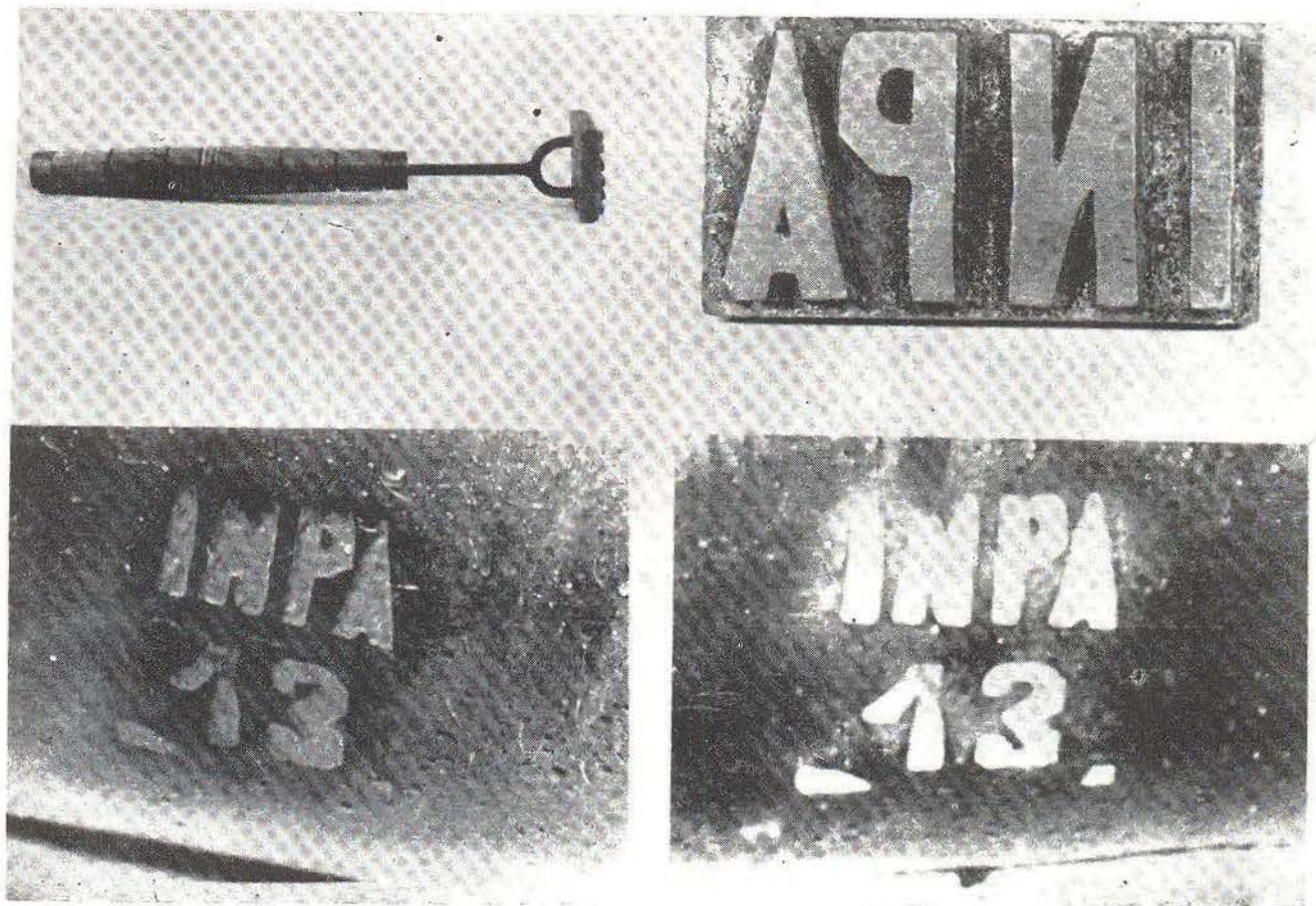
Fig. 2 — O ferrete de cobre usado para a marcação do peixe-boi, com nitrogênio líquido e a marca no dia em que foi feita e 40 dias depois.
