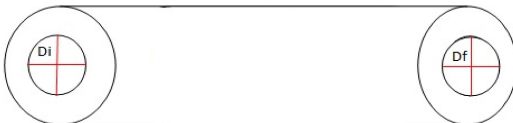
Figura 2. Medição do diâmetro médio no início e no fim de cada extremidade da tora para cubagem do volume da parte ocada.
