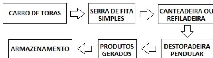
Figura 1. Fluxograma das etapas do processo de desdobro na serraria.
