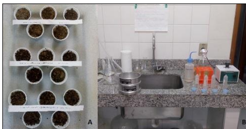
Figura 06 – Materiais usados para o procedimento de extração de esporos de FMAs em solos rizosféricos (Gerdman e Nicolson 1963). Amostras de 50 g de solo das três espécies vegetais (A); Bancada para extração dos esporos de FMA no laboratório (B).
