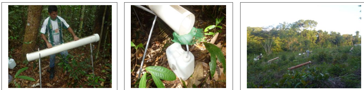
Figura 1. Instalação dos coletores de precipitação interna (A1), funil e rede de retenção (A2), coletores instalados em ares abertas (A3). Fotos: Edivan de S. Rodrigues.
