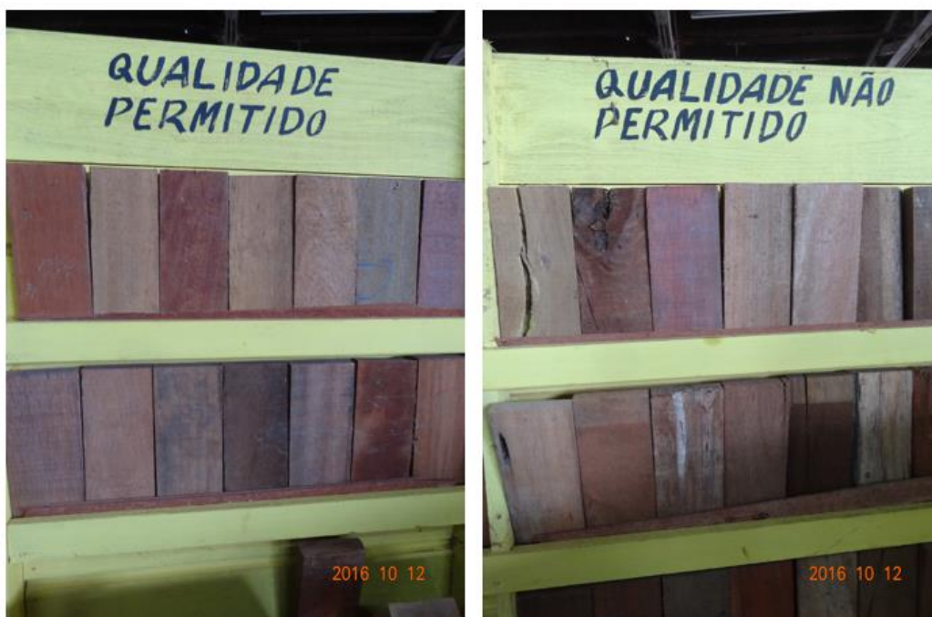
Figura 21: Exemplo de qualidades de madeira serrada permitida e não permitida para balizar a seleção das peças.
