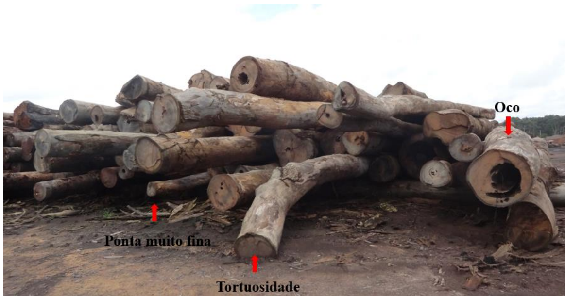
Figura 15: Toras dispostas no pátio de estocagem com alguns defeitos aparentes.
