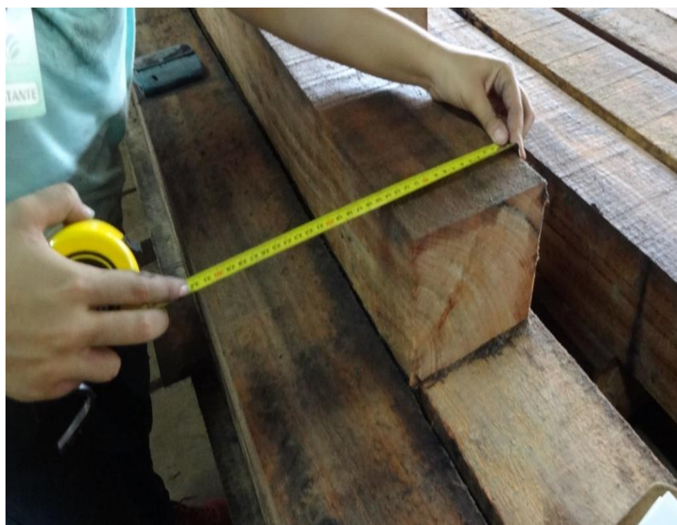
Figura 14: Mensuração da largura das peças processadas com a utilização de uma trena de 8 metros.
