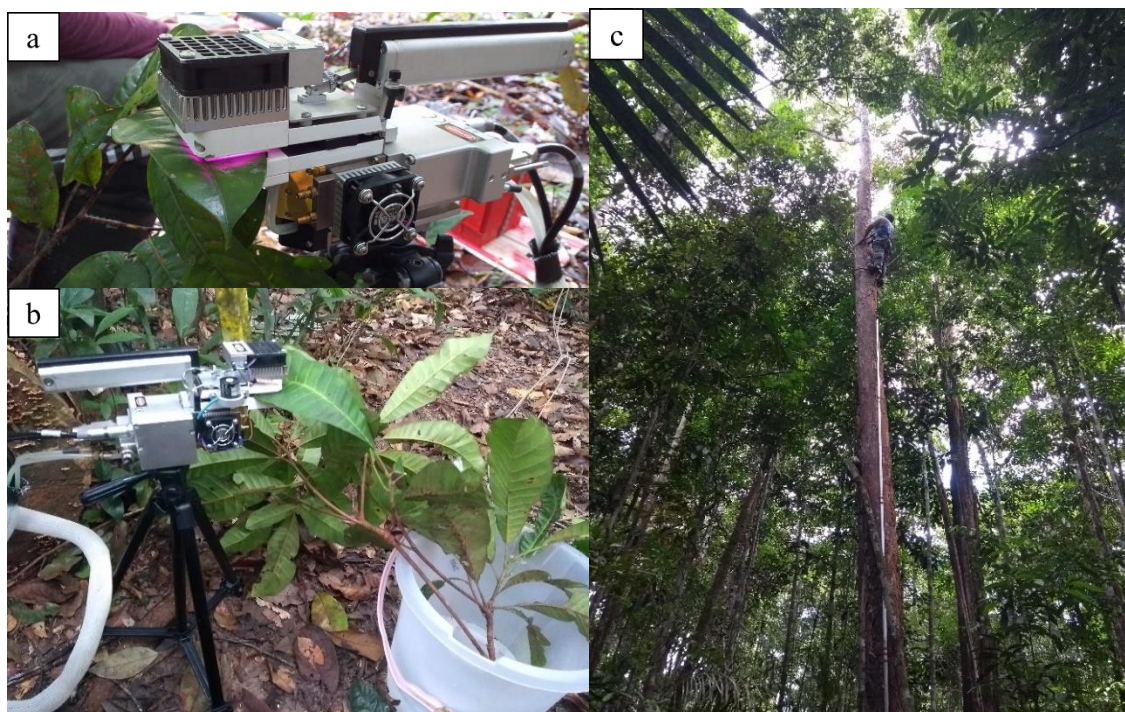
Figura 7. Licor-6400XT (a) – câmara de luz realizando medidas de trocas gasosas em uma folha; (b) – galho em balde com água; (c) – escalador subindo uma árvore para a coleta de galho.
