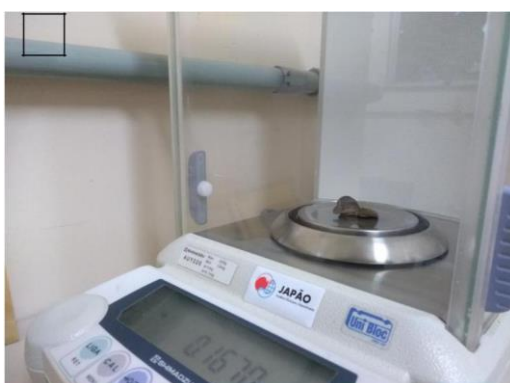
Figura 8. Pesagem dos discos de área conhecida para obtenção da AFE e MFE.
