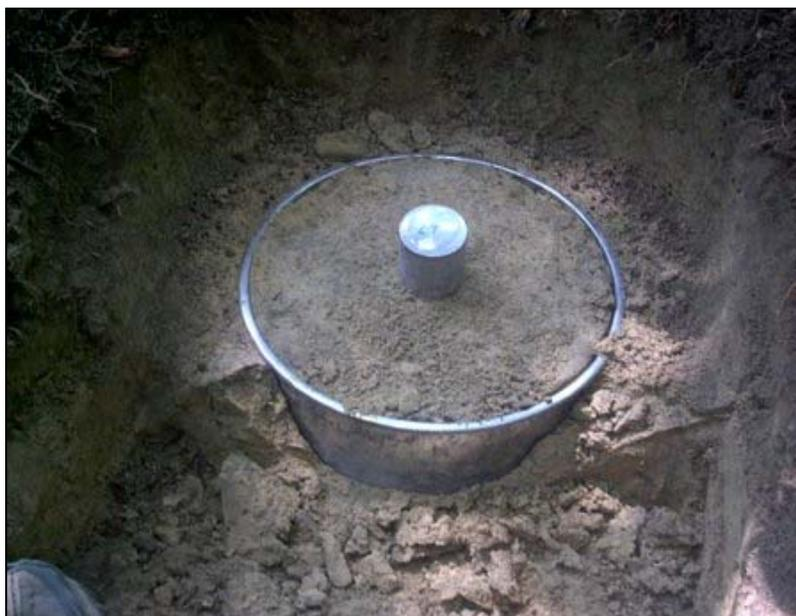
**Figura 8.** Retirada das amostras de solos em cada camada.
