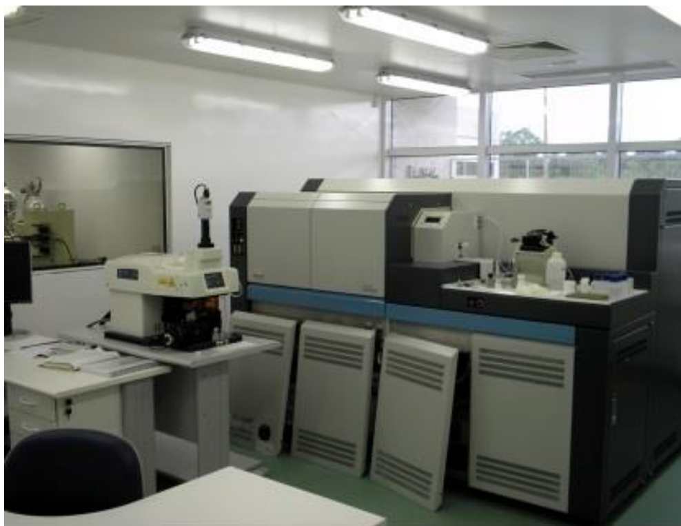
Figura 6. Sistema analítico MC-ICPMS. Fonte: Home page - Instituto de Geociências/UnB.
