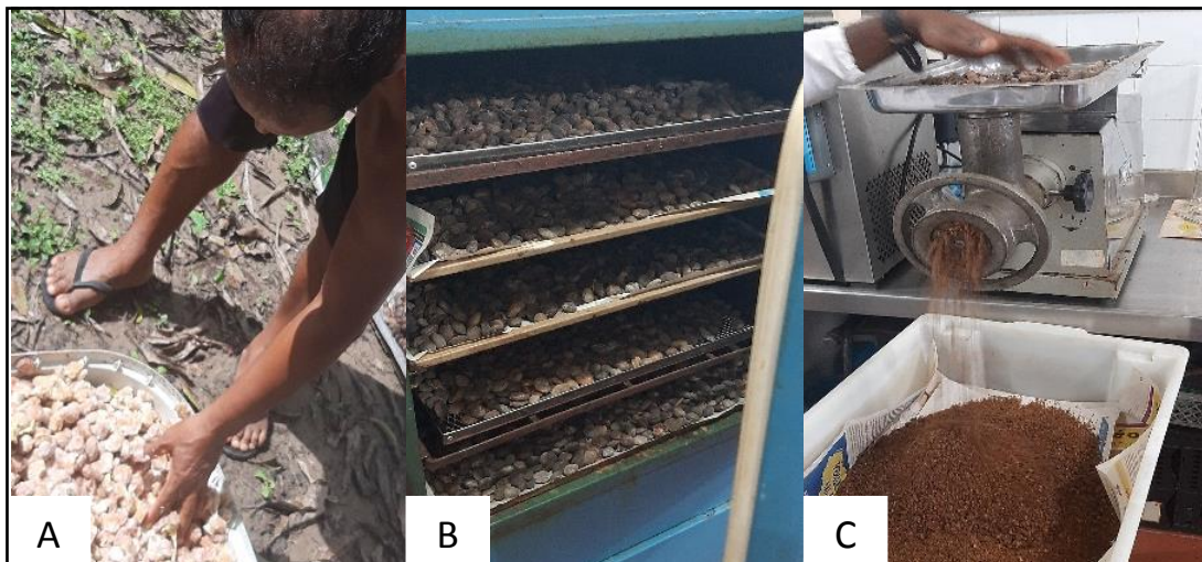
Figura 3. Preparo da Amostra. A) Pós despolpa do fruto e secagem das sementes ao sol. B) Secagem em estufa à 105°C. C) Trituração das sementes. Fonte: Tavares, 2021.
