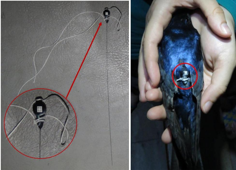
**Figura 9.** À esquerda, radiotransmissor Lotek Nanotag com amarrações, pronto para ser fixado no dorso dos indivíduos. A etiqueta branca contém o número da tag que é usado para identificação posterior dos sinais que a torre recebe. À direita, radiotransmissor fixado em um macho adulto de *P.subis*.
