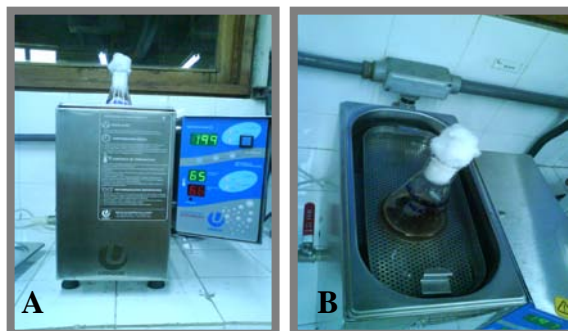
Figura 1 – Extração aquosa: A) aparelho ultrassom; B) solução extrativa em ultrassom.
