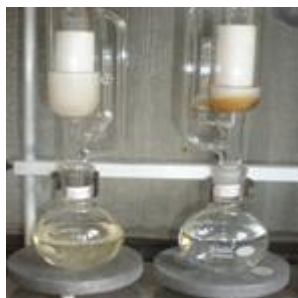
Figura 1. Extração com etanol aparelho Soxhlet
