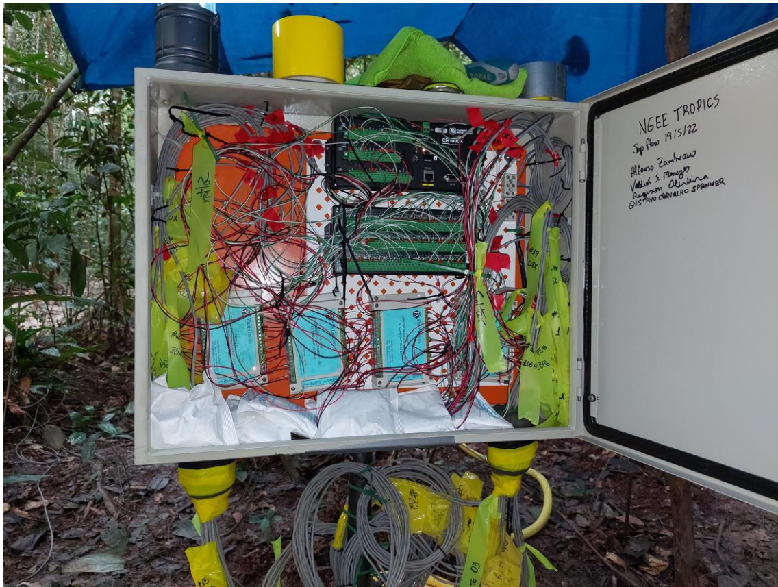
Figura 3. Sensores de fluxo de seiva conectados ao datalogger e acondicionados em caixa para armazenamento e proteção do sistema. Além disso, a caixa inclui reguladores de tensão para a energia recebida e distribuída para os sensores. A energia é fornecida por placas solares que ficam a aproximadamente a 200 m do local, na margem de uma estrada que fornecesse acesso a área.
