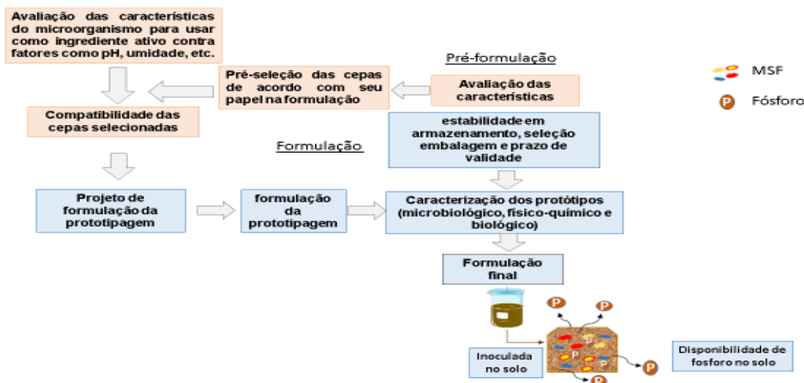
Figura 5 -Etapas necessárias no processo de desenvolvimento de formulações para produção de biofertilizantes.
