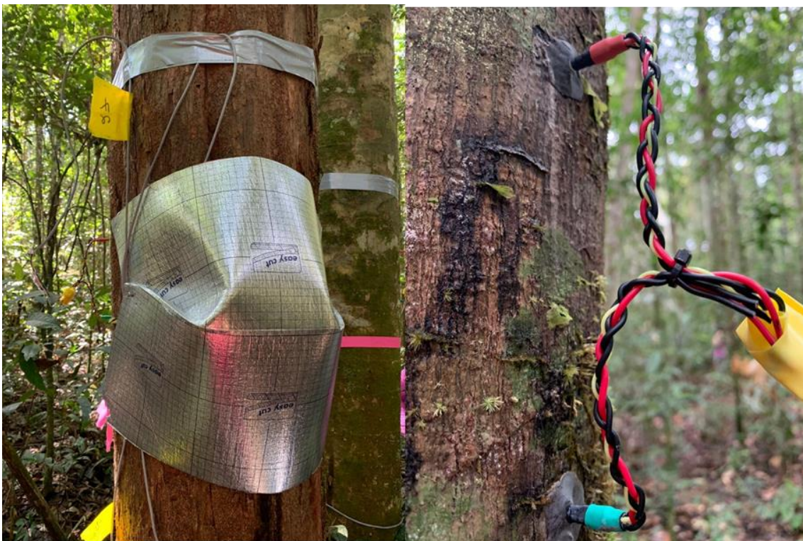
Figura 5. Exemplo de sensor de fluxo de seiva instalado em indivíduos do projeto Bionte.
