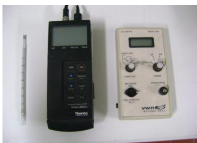
Figura 2 - Aparelhos de medição utilizados no local: Termômetro, Phmetro digital e condutivímetro digital.
