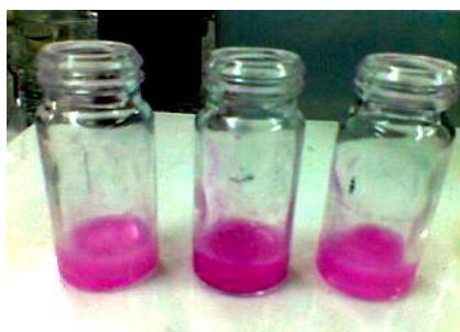
Figura 3. Amostras em testes de acidez, contendo Fenolftaleína. Fonte: Pessoa/2014
