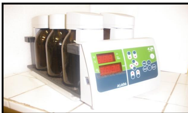
Figura 1 - Sistema respirométrico com mecanismo de agitação magnética e aparelho de comando do agitador.
