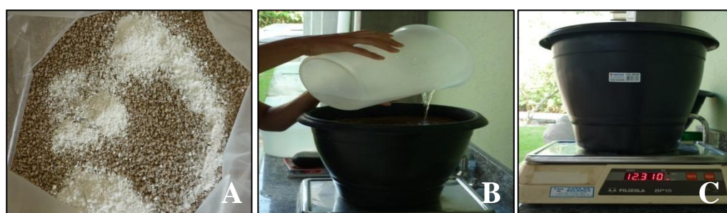
Figura 2: Etapas da aplicação de carbonato de cálcio (CaCO 3 ) e magnésio (MgCO 3 ) ao solo (A); irrigação com água destilada (B) e monitoramento da umidade do solo (C).
