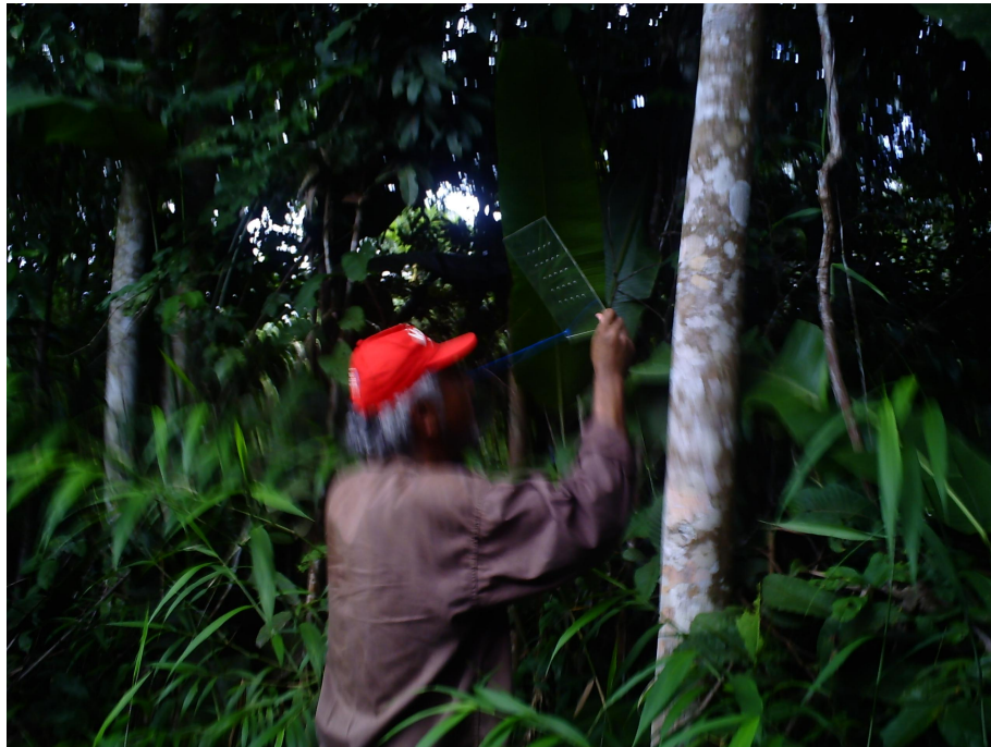
Figura 2. Área de floresta secundária, mostrando uma prática de medição da abertura de dossel com uso do instrumento Canopy-scope.
