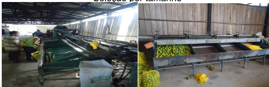
Figura 11. Processo da seleção por tamanho em grande, média e pequena das laranjas na máquina de beneficiamento, 2014.
