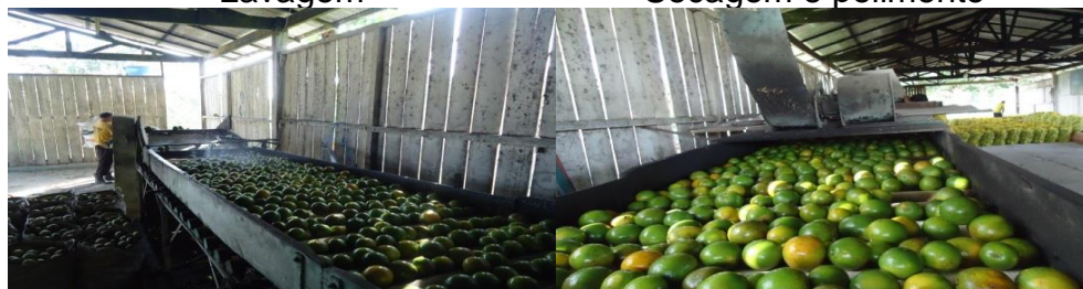
Figura 10. Processo da lavagem, secagem e polimento das laranjas na máquina de beneficiamento, 2014.
