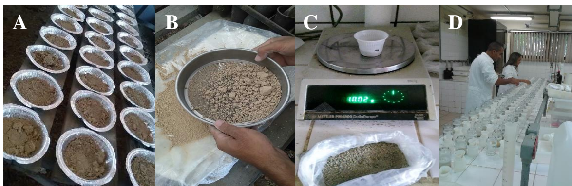
Figura 8. Secagem do solo ao ar (A); peneiramento do solo em malha de 2 mm (B); pesagem do solo (C); filtragem da solução para leitura (D).
