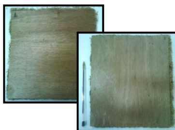
Figura 2 – Painéis aglomerados confeccionados a partir de adesivo natural e pseudocaule de bananeira
